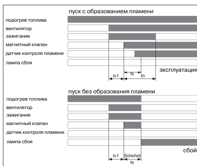
ts - контрольно-предохранительный период
